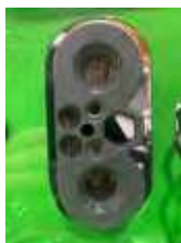
Voliteľný trojfázový nabíjací vstup DIN 320 na nakladači, A464123
